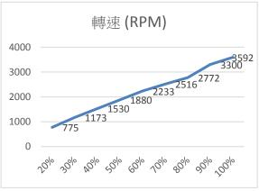
消耗電流和旋轉速度之值會因為交流變壓器的輸出電壓漂移或控制盒中元件精準度不同而有所差異。因此,+-15%的誤差是可能的。
